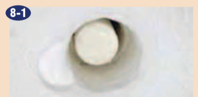
8-1 Kot je prikazano na sliki, se prešana keramika pospešeno akumulira na površini bata, če je ne odstranjujemo redno. Zaradi tega je potrebno redno čiščenje in odstranjevanje keramike z bata za pritisk.
