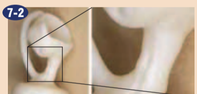
7-2 Sledi zraka, ki je ušel preko dolivnega kanala.
