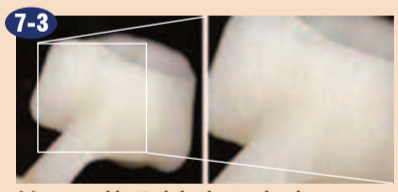
7-3 Mnogo naključnih lunkerjev kot krater.
