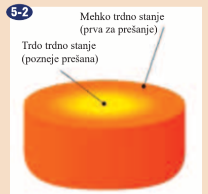
Stanje talilnega ingota v preseku.
