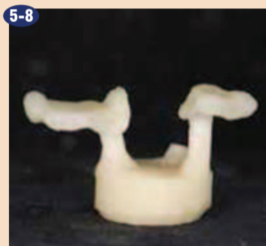
5-8 Če so dolivni kanali v takšni smeri, kot je na sliki, se pritisk ne more popolnoma izvajati do najglobljih delov izdelka, kar ima za posledico neuspeh.
