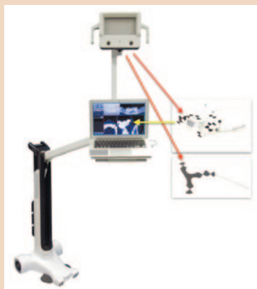
Рис. 2. Оптический датчик отслеживает положение маркера Jaw-Tracker и Drill-Tag, метчика и инструмента.
