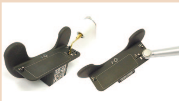
Рис. 8, а. Калибровка оси бора и его кончика.
