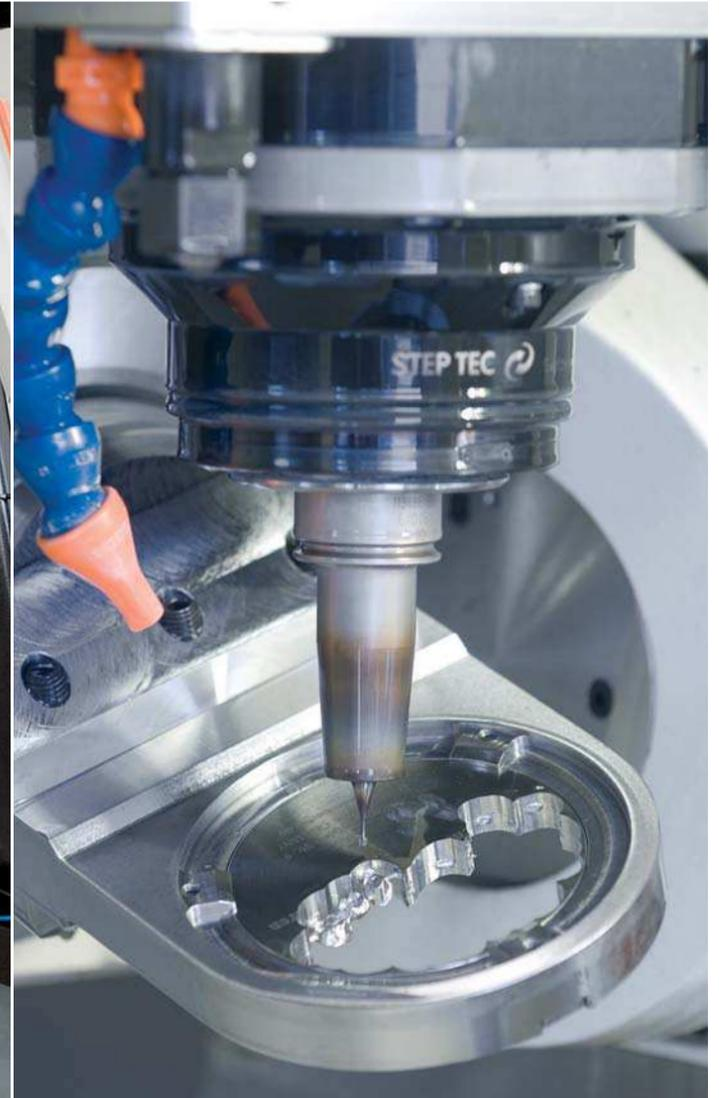
Usinage de l'armature de bridge sur une machine 5 axes.
