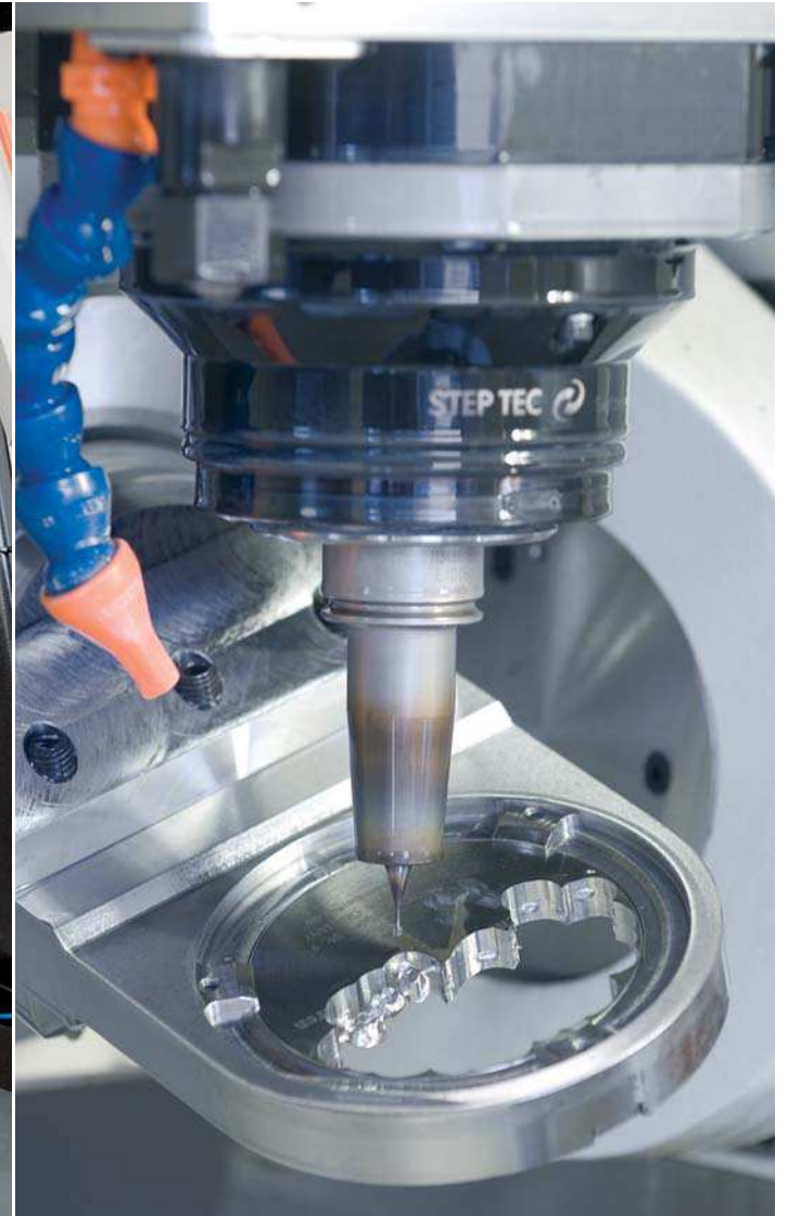
Usinage de l'armature de bridge sur une machine 5 axes.
