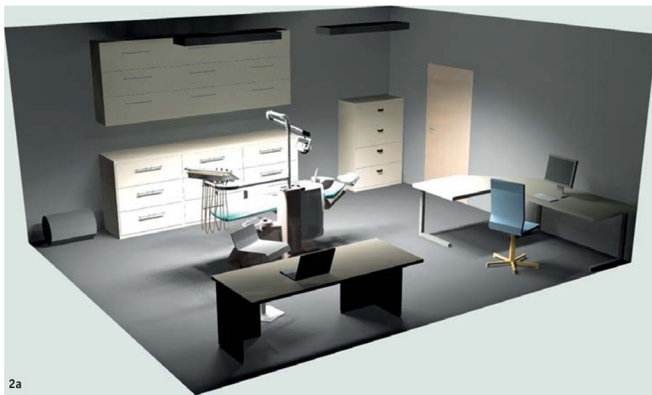
Fig. 2a : Visualisation 3D de la situation présentée à la Fig. 1a. L'éclairage est conçu sur la base des exigences relatives à un environnement de travail en bureau. L'installation ne respecte pas les zones de tâche supplémentaires. | Fig. 2b : Visualisation 3D de la situation présentée à la Fig. 1b. Un aperçu d'une salle modèle équipée d'une dalle lumineuse directionnelle / non directionnelle et d'autres luminaires supplémentaires afin de tenir compte des zones de tâche supplémentaires.
