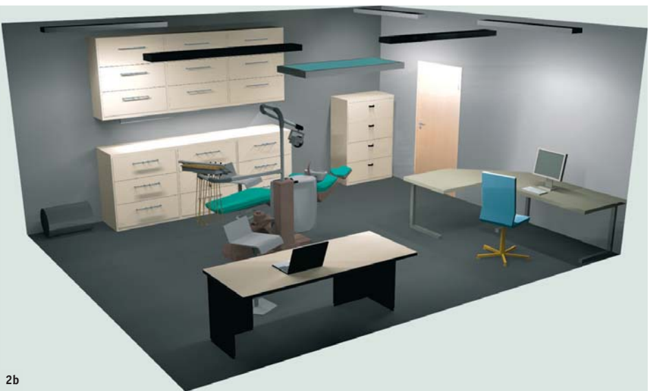
Fig. 2a : Visualisation 3D de la situation présentée à la Fig. 1a. L'éclairage est conçu sur la base des exigences relatives à un environnement de travail en bureau. L'installation ne respecte pas les zones de tâche supplémentaires. | Fig. 2b : Visualisation 3D de la situation présentée à la Fig. 1b. Un aperçu d'une salle modèle équipée d'une dalle lumineuse directionnelle / non directionnelle et d'autres luminaires supplémentaires afin de tenir compte des zones de tâche supplémentaires.
