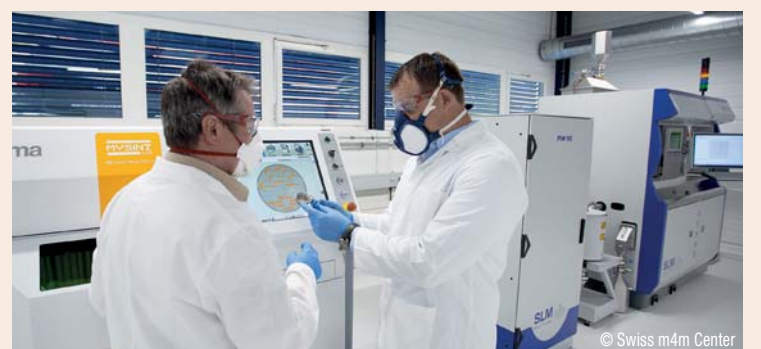
Zwei Mitarbeiter des «Swiss m4m Center» inspizieren ein Implantat aus einer Titanlegierung für die Beckenchirurgie.
