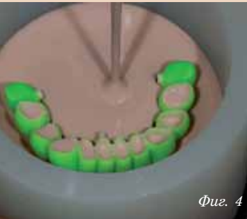
Фиг. 4: Опаковане на фрезования посредством CAD/CAM възъчен моделаж, при изработването на пресована керамика. (Благодарим за снимковия материал на Волкер Брош, Германия.)
