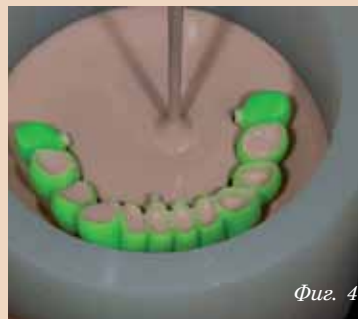
Фиг. 4: Опаковане на фрезования посредством CAD/CAM въсъчен модел, при изработването на пресована керамика. (Благодарим за снимковия материал на Волкер Брош, Германия.)
