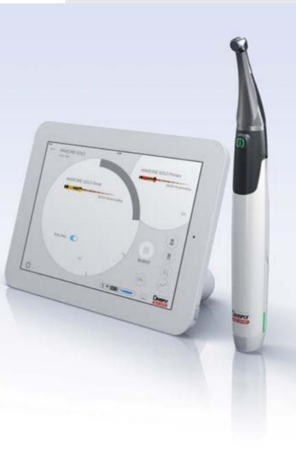
néficiant d'une lisibilité et d'une navigation améliorées grâce à la visualisation sur iPad mini, comme enregistrer une séquence instrumentale personnalisée ou modifier la vitesse et valeur de couple d'un instrument. iQ offre de nombreuses fonctions support, telles l'indication du torque employé sur l'instrument ou le module éducation-patient pour expliquer les différentes étapes du traitement endodontique jusqu'à la restauration coronaire, à l'aide de visuels didactiques.
