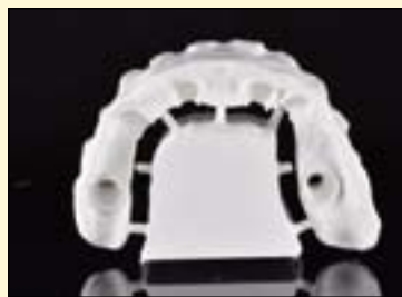
图2：使用氧化锆制作支架（Zenostar）。
