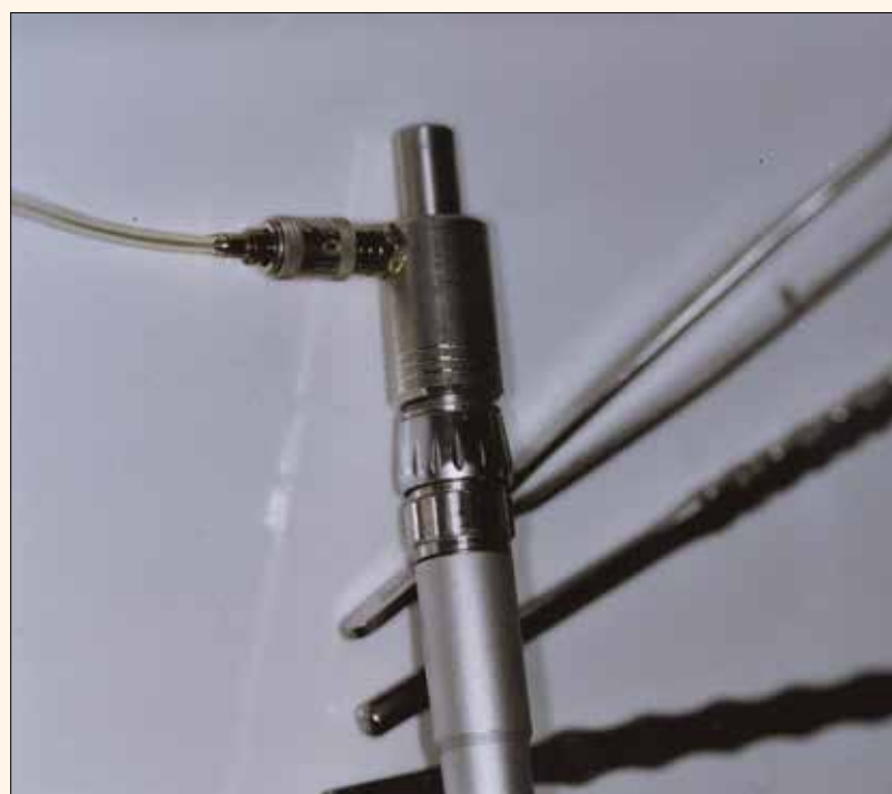
Fig. 2 : Il existe un adaptateur pour le raccordement à chaque turbine (et pour le raccordement au compresseur d'air des laboratoires dentaires).
