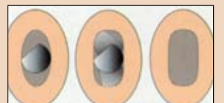
Εικ. 4 Εικόνα ενός ασύμμετρα σχεδιασμένου εργαλείου και της δυνατότητάς του να διαχωρίζει και να καθαρίζει ένα σωλήνα με ωσειδή διάμετρο.
