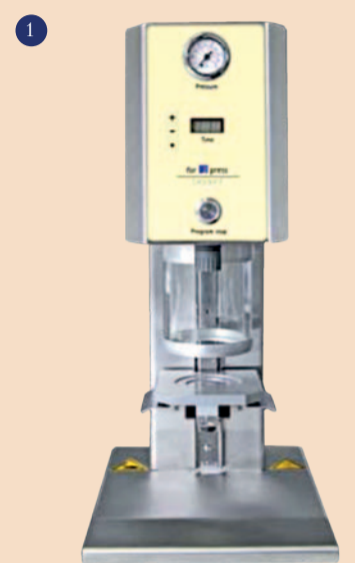
Vakumska »press« peč »for 2 press«.
