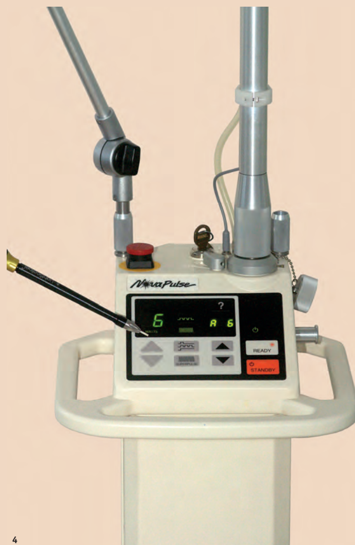
Abb. 4: CO 2 -Laser mit Handstück mit Keramikspitze (links).
