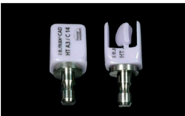
Fig. 6 - I blocchetti di disilicato da fresare e fresati.
