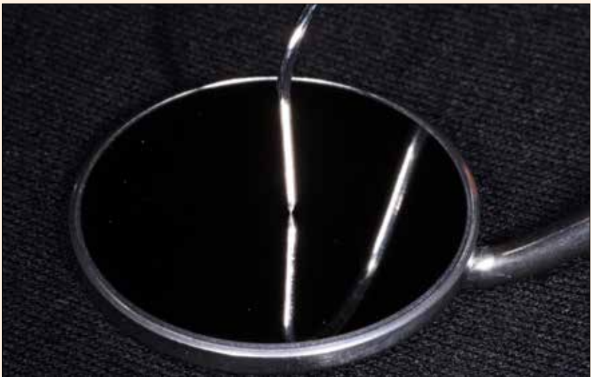
Espejo tipo front surface mirror que refleja una continuidad de imagen.
