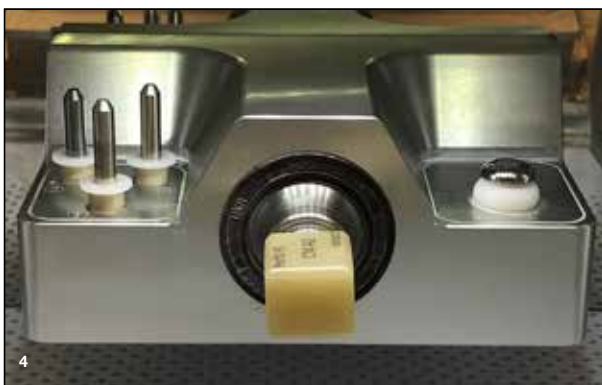
Slika 4: Menjava orodij poteka s pomočjo pnevmatskega vpenjalnega sistema; dolžina orodij se samodejno izmeri s pritiskom na gumb na desni strani slike.
