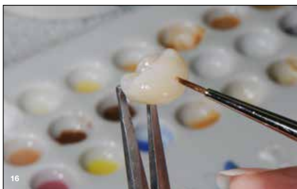
Slika 16 in 17: Dokončanje kron z pečenjem in glazuro.
