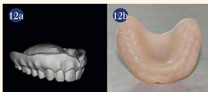
Slike 12.a i b: STL podaci (a) i 3D ispisana probna proteza (b).
