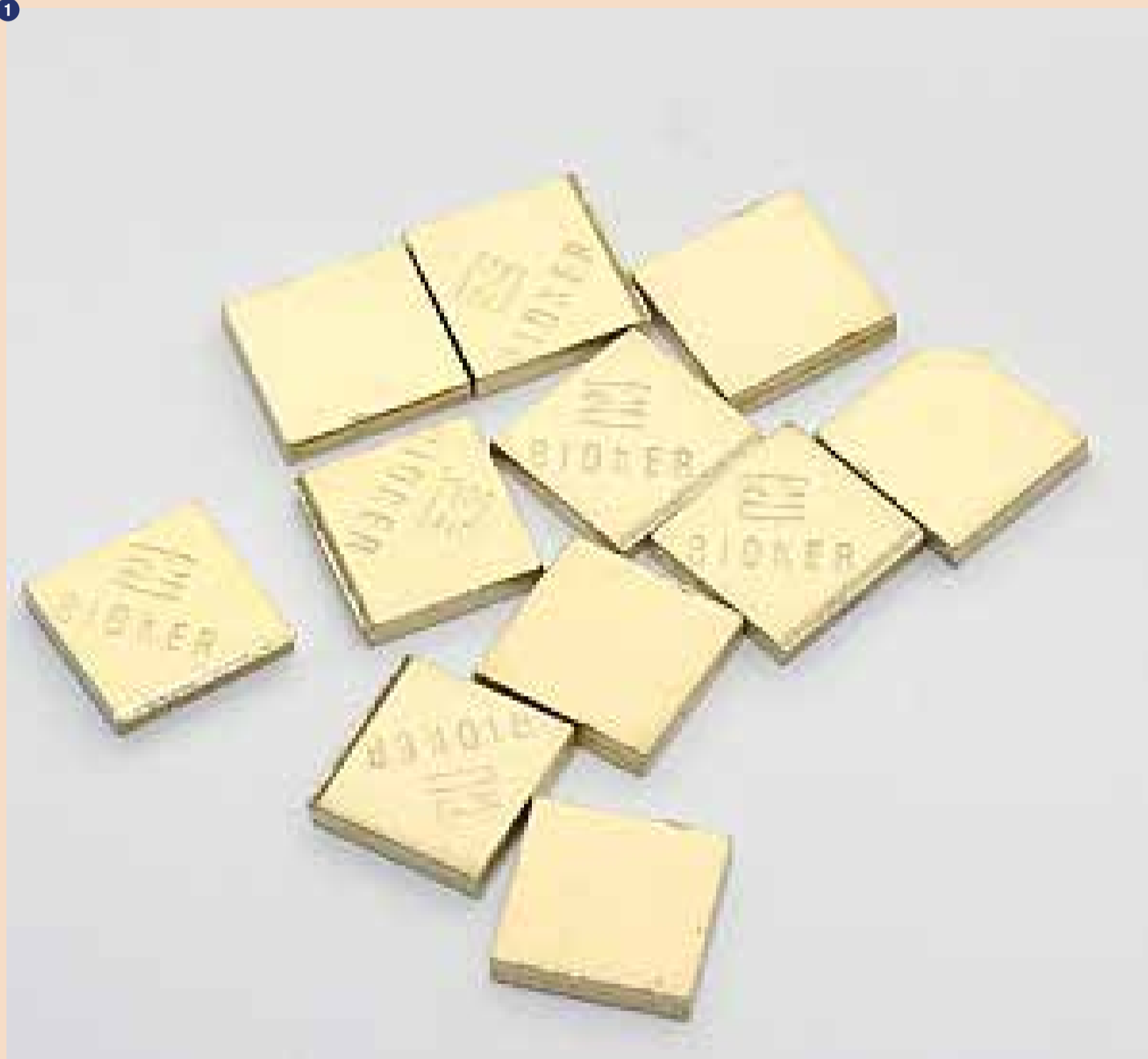
Bioker dentalna zlitina (kemijska sestava 85,9 m.% Au, 11,7 m.% Pt, 1,7 m.% Zn) – proizvajalec Zlatarna Celje d.o.o.
