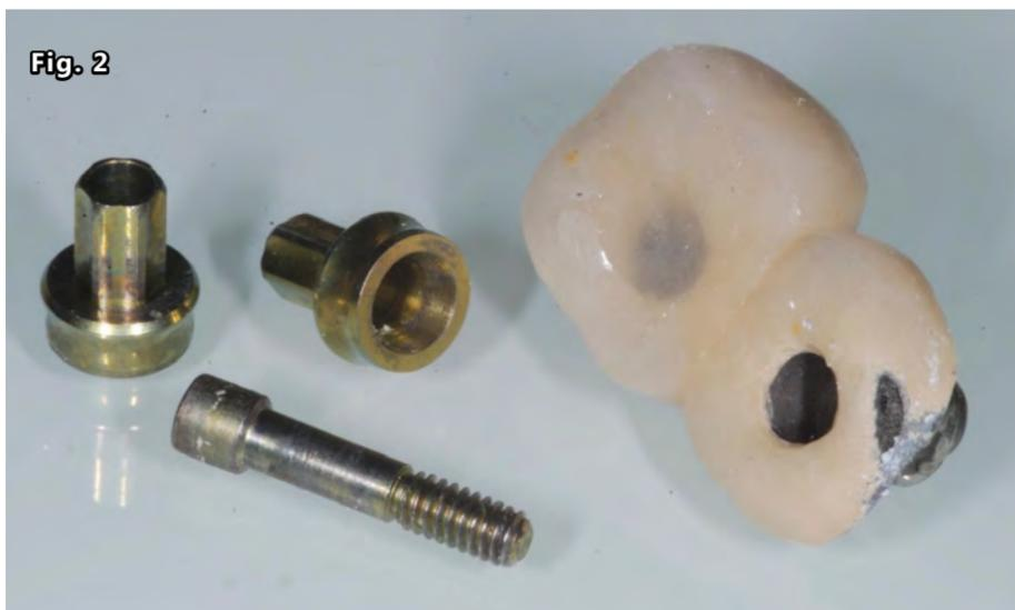
**Figura 2.** La presencia de un solo tornillo con la cabeza con el encaje para el destornillador y la integridad del relleno del orificio de acceso oclusal en el elemento 4.6 sugería que el segundo tornillo estaba fracturado. De lo contrario, el artefacto protésico no podría haberse desprendido.
