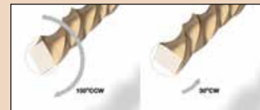
Εικ. 4 Η ρίνη περιστρέφεται κατά 150 μοίρες αντίθετα με τη φορά των δεικτών του ρολογιού και 30 μοίρες κατά τη φορά των δεικτών του ρολογιού, πραγματοποιώντας περιστροφή 360 μοιρών μετά από τρεις κύκλους παλινδρομικής κίνησης.
