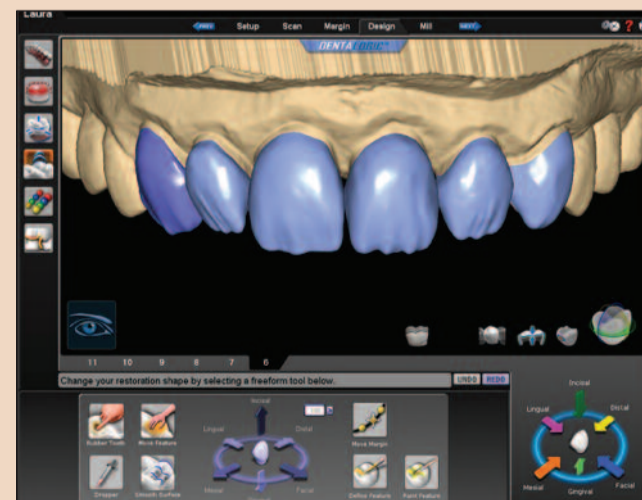
Рис. 10. Готовая модель окончательных реставраций, предусматривающая последующее нанесение слоя керамики в области режущего края.
