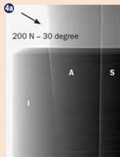
Sliki 4a in b: Rentgenski posnetek (a) Ankylos C/X implantata brez obremenitve (ANO1) in (b) Implantat Straumann Bone Level (STO2) z obremenitvijo 200 N pri 30-stopinjskem kotu. I-implantat, A-opornik, S-vijak.
