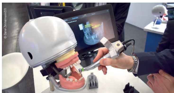
• Das System erlaubt einen Einblick in die Behandlungssituation während einer Implantation in Echtzeit. • The system provides a real-time view of the treatment situation during implantation.
