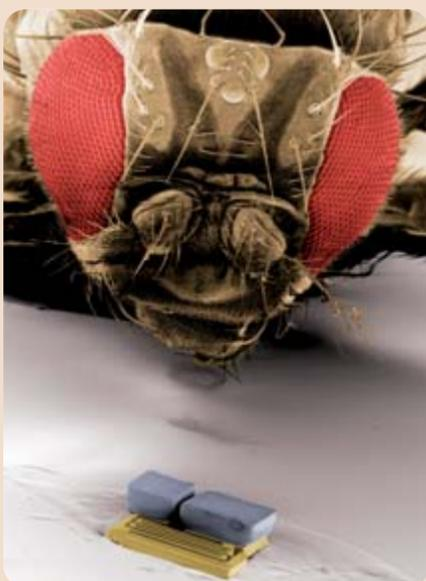
Mit dem nur einen Drittel Millimeter großen Roboter im Bild (Vordergrund) sollen künftig Substanzen zielgerichtet an den benötigten Ort im Gewebe transportiert werden. (Foto: SNF)
