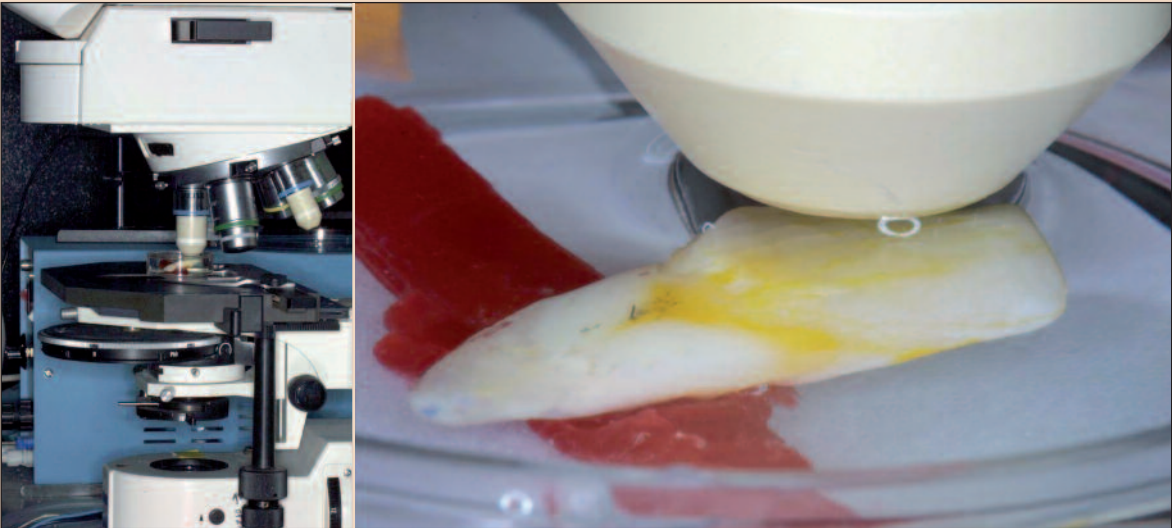
Рис. 2а, б. Общие условия проведения софокусной микроскопии (а). Спрямленный участок поверхности резца размещен перпендикулярно лучу лазера (б). Образец погружен в дистиллированную воду.
