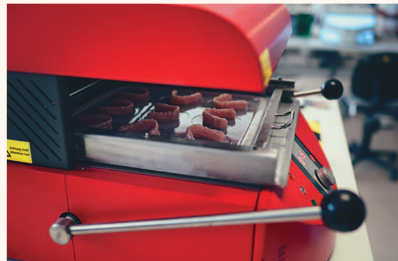
Модели зубных рядов, на базе которых затем создают элайнеры, изготавливаются по методу 3D-печати. (Фото: PlusDental)
