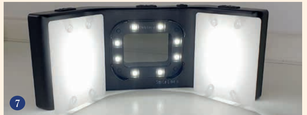
Slika 7. Smile Lite MDP s postavljenim difuzorima i polarizacijskim filterom- hibridno osvjetljenje.
