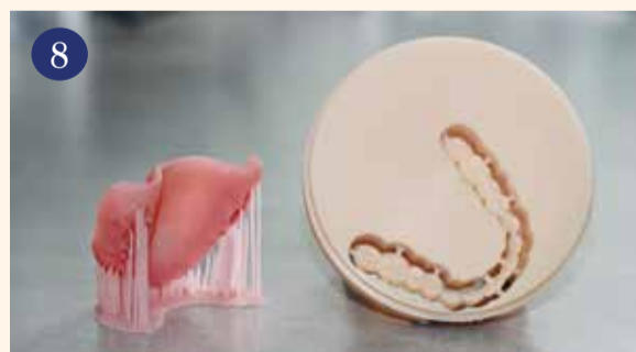
Slika 8. 3D ispisana baza i glodani zubi s osloncima.
