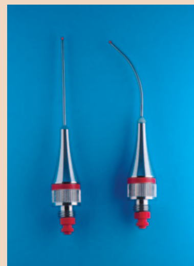
Рис. 10. После стерилизации игла приобретает исходную форму
