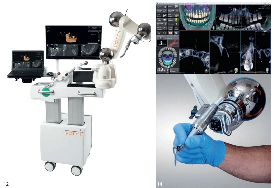
Fig. 12 : Le robot dentaire Yomi, conçu pour assister lors de la pose d'implants dentaires, offrant une navigation chirurgicale robotisée avec un contrôle précis en temps réel (Neocis). Fig. 13 : Capture d'écran du logiciel Navident, développement en cours de l'IA pour le tracé du V3, de la courbe panoramique, et de la segmentation (Dr Jacques Vermeulen). Fig. 14 : Gros plan du bras robotisé Yomi en action, guidant une main humaine lors d'une intervention chirurgicale dentaire pour un placement précis des implants (Neocis).
