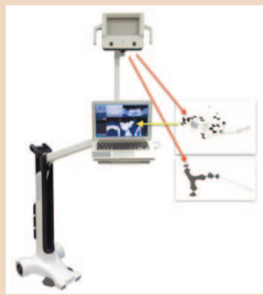
Рис. 2. Оптический датчик отслеживает положение маркеров Jaw-Tracker и Drill-Tag, метчика и инструмента.
