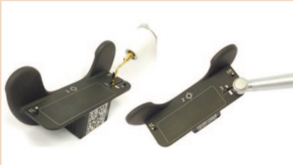
Рис. 8, а. Калибровка оси бора и его кончика.
