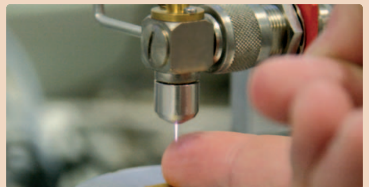
Im Bild die am IOM Leipzig entwickelte miniaturisierte Plasmaquelle mit gezündetem Plasmajet.
