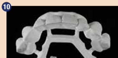
10 Cirkonij v zeleni fazi, pred sintranjem. Zahvaljujoč digitalizaciji je vsak primer ponovljiv.
