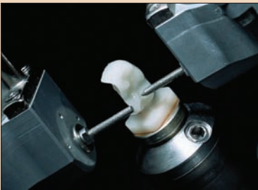
Şekil 4. CEREC 3 cihazına ait freze ünitesi.
