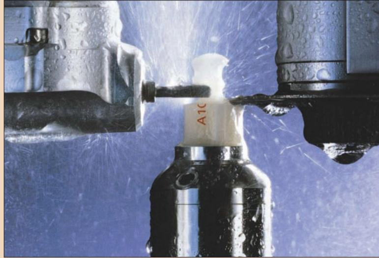
Şekil 2. CEREC 2 cihazında kullanılan aşındırıcı disk ve silindirik frez.
