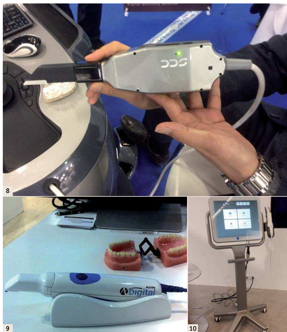
Fig. 8 : Scanner intra-oral taiwanais Dental AEGIS PO acquisition par clichés successifs avec poudrage. | Fig. 9 : Prototype de scanner intra-oral ADIN. Lancement prévu pour 2016. | Fig. 10 : iTero Element, la 3 e génération d'iTero.
